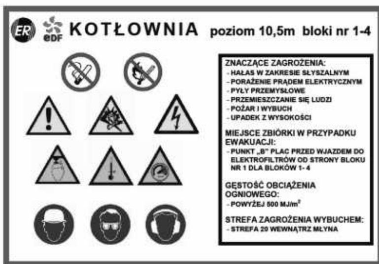
Rys. 1. Tablica informacyjna o zagrożeniach w miejscu pracy
