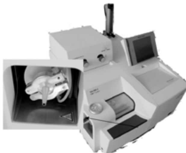
Fig. 1. TGA/DSC testing analyzer with detail of hot part (left) Rys. 1. Analizator testowy TGA / DSC ze szczegółami części gorącej (po lewej)
